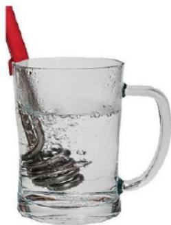
> Un thermoplongeur peut être assimilé à un conducteur ohmique. Son rendement est égal à 1.
